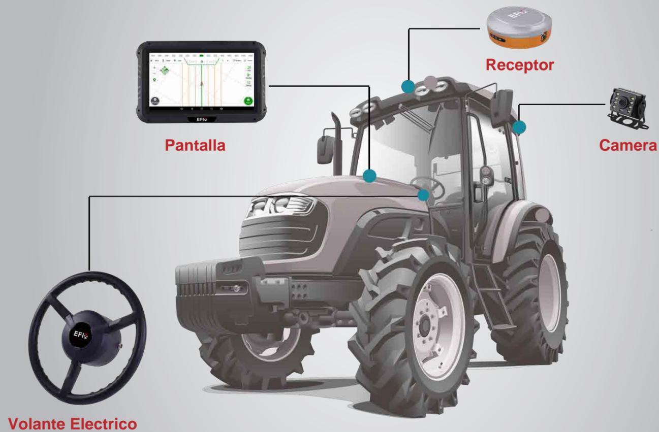
El eSteer 10 El sistema cuenta con un controlador todo en uno que integra un módulo 4G, un sensor IMU y un módulo GNSS, lo que facilita la instalación y la transferencia entre vehículos. No se requiere un sensor de ángulo de rueda adicional para el eSteer 10, lo que mejora aún más su facilidad de instalación.
